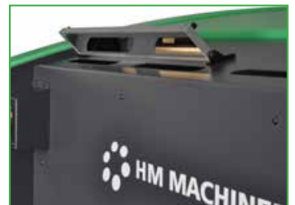
Einfache Erkennung der Schnittlinie über den Spiegel
